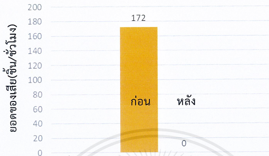
รูปที่ 4.9 เปรียบเทียบยอดของเสียก่อนและหลังการเปลี่ยนรูปแบบปากHopper
