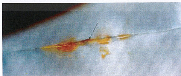
รูปที่ 2.8 ลักษณะของเสียที่เกิดจากรอยรั่ว
