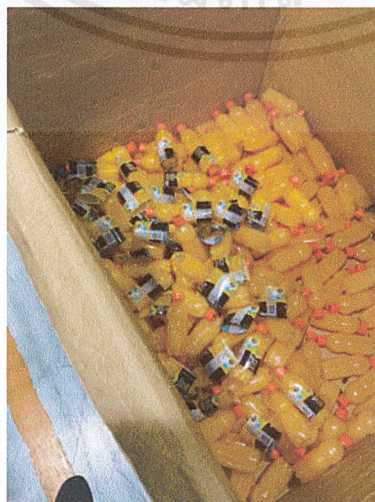
รูปที่ 3.3 ขวดที่เครื่องคัดออกหลังจากการสวมฉลาก
