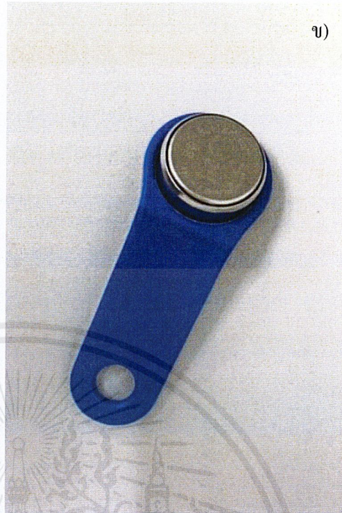
รูปที่ 3.7 เครื่องบันทึกข้อมูลอุณหภูมิ (ก) ชนิดโพรบ และ (ข) ชนิดกระดุม
