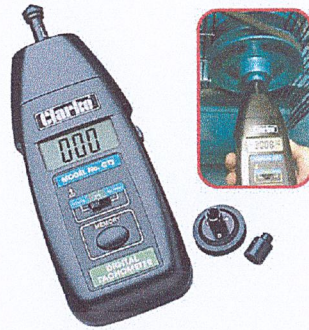
รูปที่ 2.27 เครื่องวัดความเร็วรอบแบบ Tachometer
