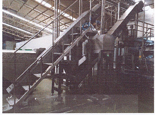
รูปที่ 2.7 สกรูลำเลียงสำหรับบดเนื้อมะพร้าว
