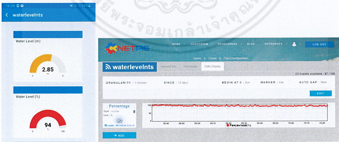
รูปที่ 4.6 การแสดงผลระดับน้ำออนไลน์บน Application และ กราฟแสดงการบันทึกข้อมูลระดับน้ำบนคลาวด์ (Cloud Computing) ผ่าน NETPIE Website
