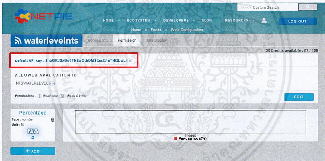
รูปที่ 3.29 การกำหนดสิทธิในการเข้าถึง FEED โดยใช้ API Key
