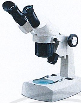
รูปที่ 3.3 กล้องจุลทรรศน์แบบแสงกำลังขยายต่ำ
