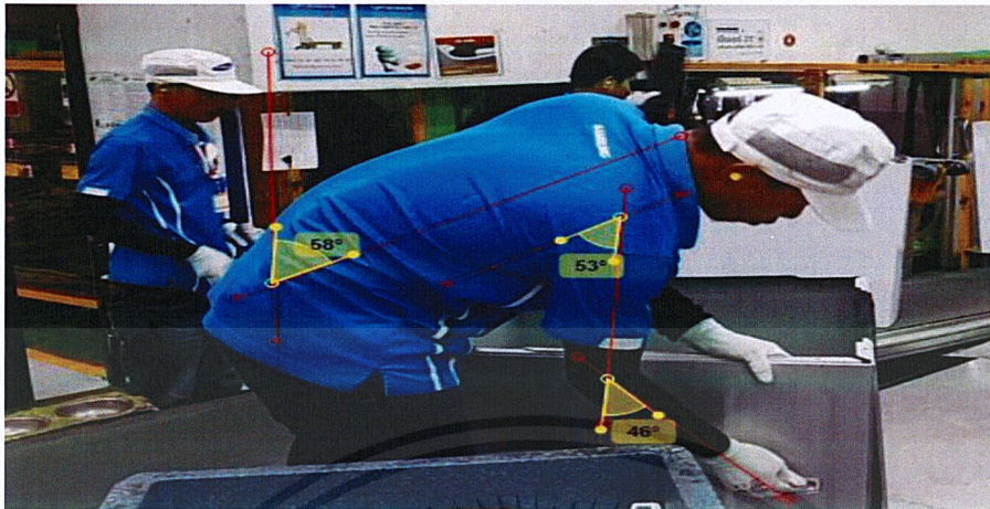
รูปที่ 3.18 ท่าทางการทำงานที่มีความเสี่ยงที่สุดกระบวนการ Assy handle
