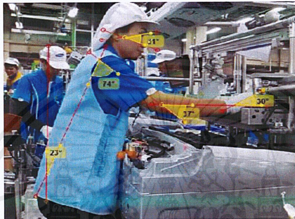
รูปที่ 4.22 แสดงท่าทางการทำงานก่อนทำการปรับปรุงของกระบวนการ Load Control Panel
