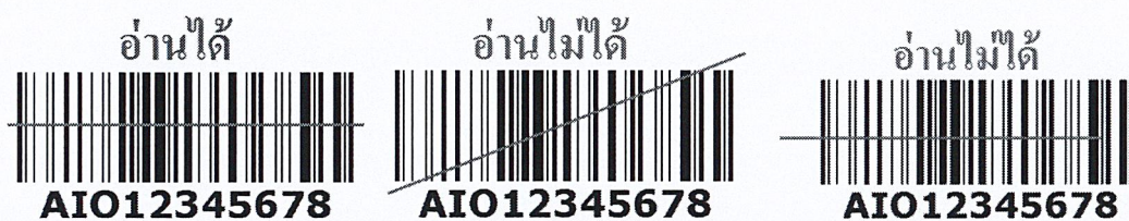
รูปที่ 2.37 บาร์โค้ดที่อ่านไม่ได้ [42]
