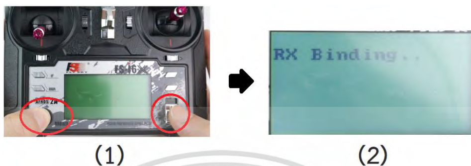
ภาพที่ ๓.27 การแสดงผลของหน้าจอเมื่อเข้าโหมด Rx Binding
