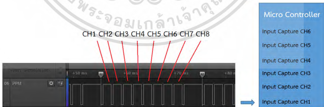
ภาพที่ 2.13 สัญญาณการควบคุมที่ออกจากชุดรับสัญญาณที่ใช้โหมด PPM
