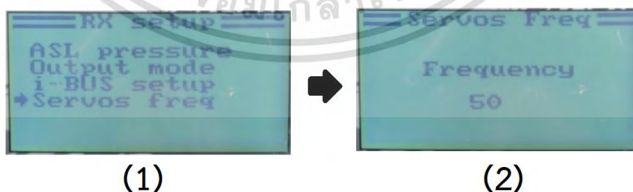
ภาพที่ ฌ.18 การตั้งค่า Servos Freq
