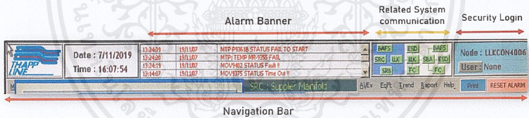
รูปที่ 3.22 ส่วนหัวของหน้าจอ SCADA
