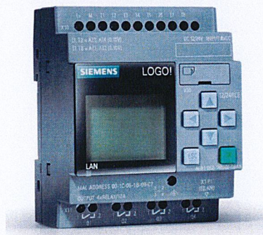
ภาพที่ 2.8 ตัวอย่างพีแอลซี (PLC) ที่ใช้ในระบบ
