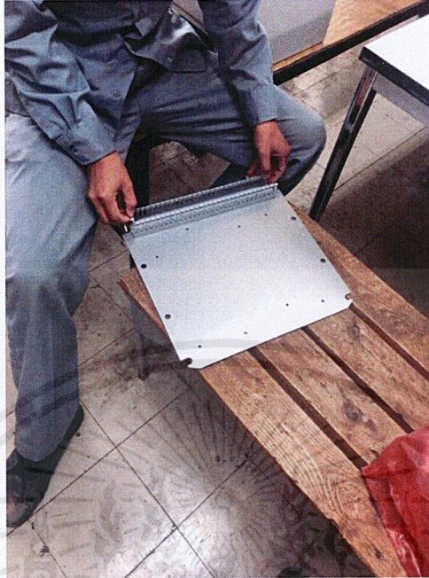
ภาพที่ 3.36 การติดตั้ง Trunk เพื่อที่จะนำไปใช้เป็นที่เก็บสายไฟ
