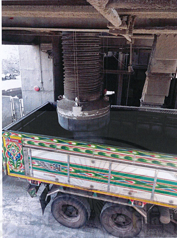
ภาพที่ 3.50 ตัวอย่างการจ่ายปูน Clinker ของหัวจ่าย Clinker ระหว่างการทำ Simulation Test
