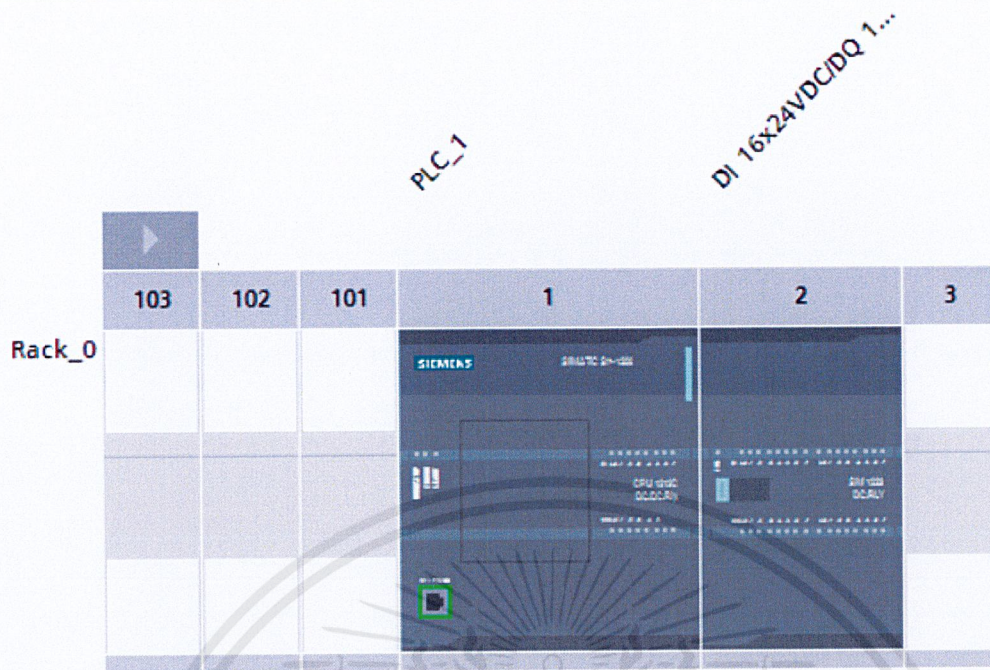
ภาพที่ 3.54 การจัดวางของ CPU และ I/O Module
