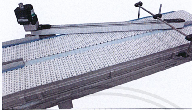
ภาพที่ 2.45 เครื่องเปลี่ยนทิศทางการลำเลียงวัสดุบนสายพานลำเลียง
