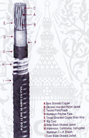
รูปที่ 2.36 สาย Pair P-OS (Multiple Non-Shielded Pairs/Triads - Overall Shield)
