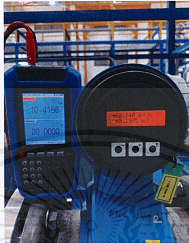
(b) อัตราการไหลและสัญญาณเอาต์พุตที่อ่านได้จากอุปกรณ์ที่เข้าสอบเทียบ
