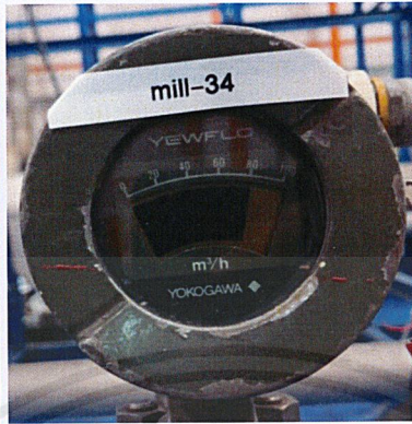
(b) อัตราการไหลและสัญญาณเอาต์พุตที่อ่านได้จากอุปกรณ์ที่เข้าสอบเทียบ
