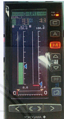
(c) อัตราการไหลที่อ่านได้จากอุปกรณ์ที่เข้าสอบเทียบในห้องควบคุม
