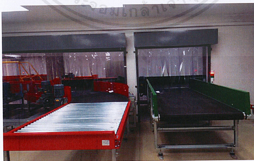
รูปที่ 3.5 ห้องตรวจสอบสัมภาระกรณีเครื่องสแกนตรวจเจอวัตถุต้องสงสัย
