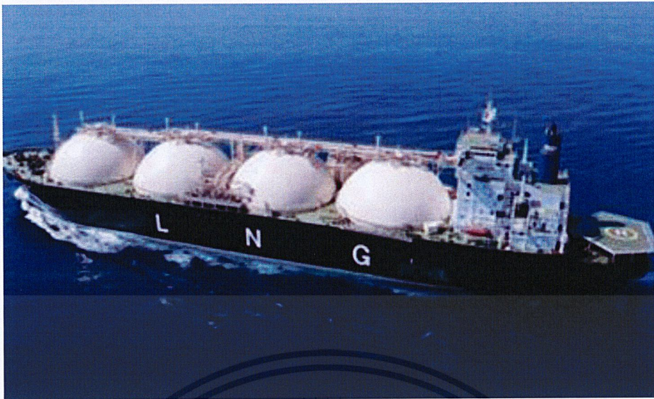
รูปที่ 2.5 เรือ LNG Self-Supporting - MOSS Type [8]
