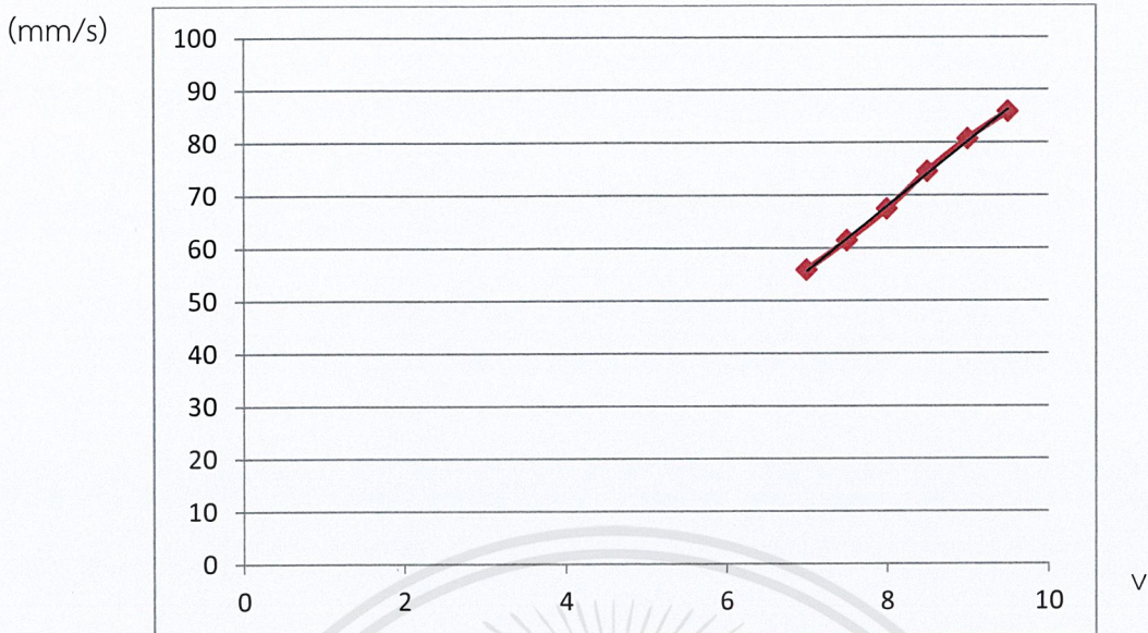
รูปที่ 4.3 กราฟความสัมพันธ์ระหว่างอัตราความเร็ว (mm/s) กับแรงดันไฟฟ้าของสายพานลำเลียง B
