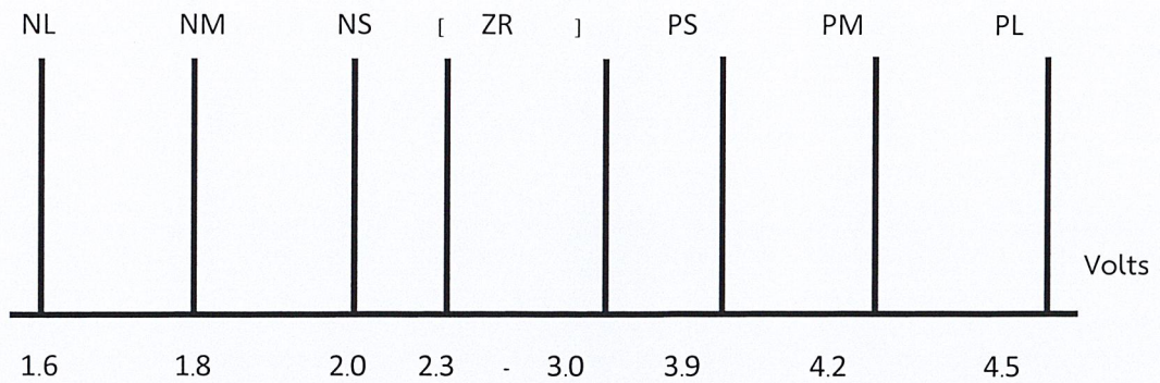
รูปที่ 3.7 Membership Function Output กับ แรงดันที่ D/A เพื่อขับ Conveyor A
