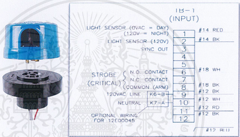
รูปที่ 4.15 แสดงอุปกรณ์ photocell และการเชื่อมต่อ
