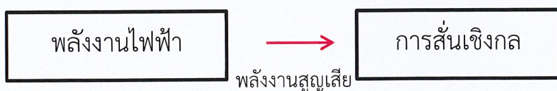
ภาพที่ 2.12 การทำงานของทรานสดิวเซอร์ชนิด Piezoelectric
