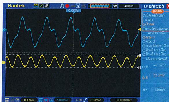
ภาพแสดงการกรองสัญญาณความถี่เสียง 881 Hz ที่ความถี่คัตออฟ 881 Hz
