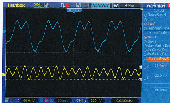
ภาพแสดงการกรองสัญญาณความถี่เสียง 675 Hz ที่ความถี่คัตออฟ 2000 Hz
