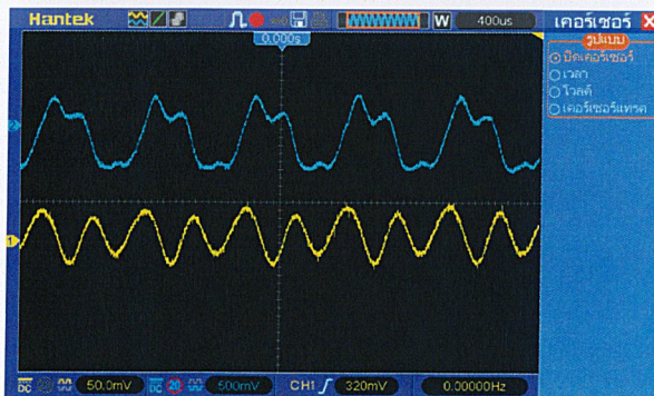
ภาพแสดงการกรองสัญญาณความถี่เสียง 800 Hz ที่ความถี่คัตออฟ 800 Hz
