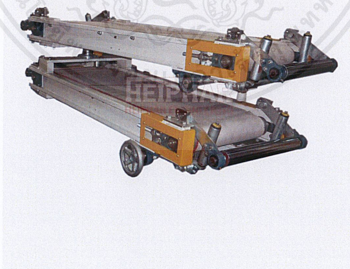
ภาพที่ 2.1 ภาพระบบสายพานลำเลียง (Belt Conveyor)
