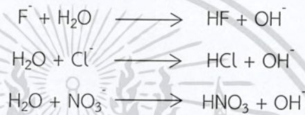
รูปที่ 4.9 แสดงการเกิดปฏิกิริยาระหว่างไอออนลบที่ตรวจพบกับน้ำ
