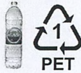
รูปที่ 2.5 รหัสรีไซเคิลของพอลิเอทิลีนเทเรฟทาเลต (บทความวิทยาศาสตร์ สารเคมีในชีวิตประจำวันเกี่ยวกับพลาสติก, 2550)
