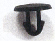
ภาพที่ 4.3 คลิปสำหรับบริเวณมุม Door Weatherstrip
