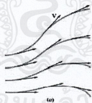
รูปที่ 2.36 เส้นกระแสของอนุภาคในของไหลและความเร็วของอนุภาคขณะผ่านจุด v
