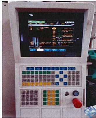
รูปที่ 2.4 หน่วยควบคุม (Control Unit)
