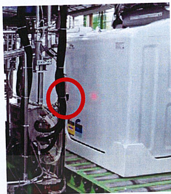
รูปที่ 3.17 เซนเซอร์ตรวจจับวัตถุชนิดแสงที่ถูกติดตั้งในสายการผลิต
