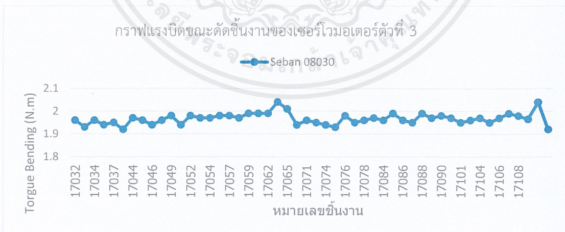
รูปที่ 4.6 กราฟแสดงค่าแรงบิดจากเซอร์โวมอเตอร์ตัวที่ 3 ขึ้นงานรุ่น 08030
