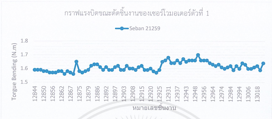
รูปที่ 4.11 กราฟแสดงค่าแรงบิดจากเซอร์ไวโมเตอร์ตัวที่ 1 ชิ้นงานรุ่น 21259
