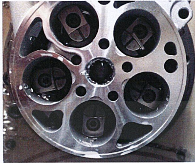
รูปที่ 3.3 การจับชิ้นงานของ Process Head side Turning (Front และ Rear)
