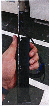
รูปที่ 3.29 ภาพ Photo sensor ของ Omron และที่ยึดเซ็นเซอร์ที่ประดิษฐ์ขึ้นเองด้วยการเชื่อมเหล็ก
