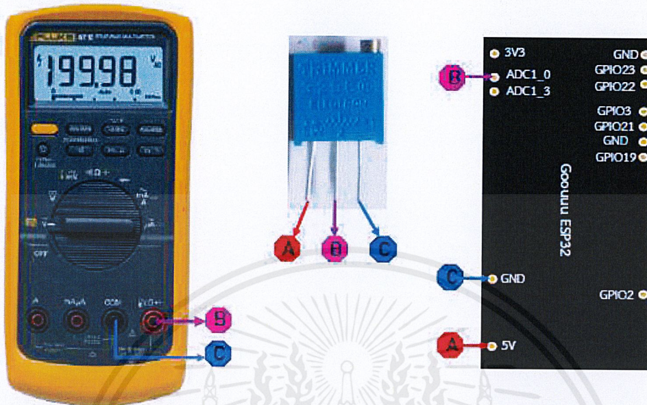
รูปที่3.29 วงจรหาความสัมพันธ์ระหว่างค่าอนาล็อกกับแรงดันไฟฟ้ากระแสตรง(วัดค่าโดยตรง)
