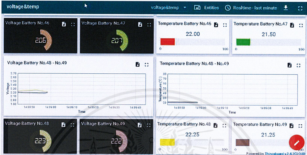
รูปที่4.1 การแสดงค่าแรงดันไฟฟ้ากระแสตรงและอุณหภูมิบน Dashboard (1)
