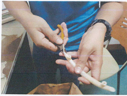
รูปที่ 3.15 การตัดก้านผลิตภัณฑ์มือจับพลาสติกรุ่น 96KV
