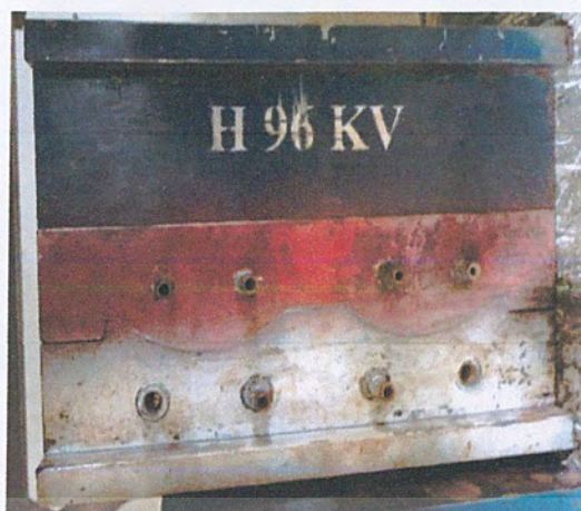
รูปที่ 3.4 การเตรียมแม่พิมพ์ผลิตภัณฑ์มือจับพลาสติก รุ่น 96KV
