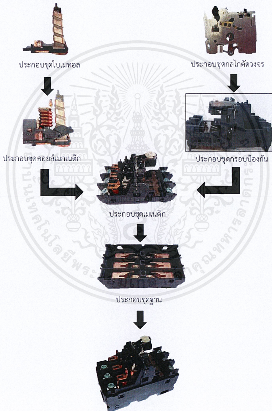
รูปที่ 3-2 ลำดับการประกอบและชิ้นส่วนของเซอร์กิตเบรกเกอร์GV2ในส่วนของไลน์การประกอบย่อย
