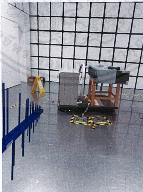
รูปที่ 3.22 ขณะทำการทดสอบการแพร่สัญญาณรบกวนผ่านอากาศด้วย TBM
