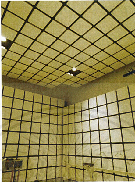
รูปที่ 2.6 ห้องปิดกั้นคลื่นแม่เหล็กไฟฟ้า
