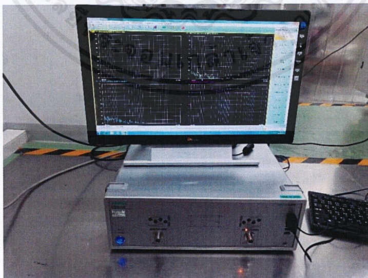
รูปที่ 3.2 อุปกรณ์วิเคราะห์เครือข่ายเวกเตอร์และหน้าจอคอมพิวเตอร์
