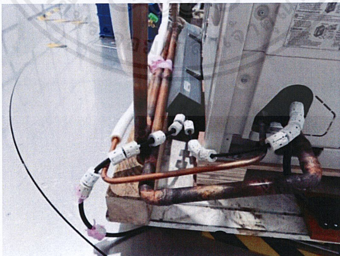
รูปที่ 3.19 แกนเฟอร์ไรต์คล้องที่สายสัญญาณเชื่อมต่อระหว่างเครื่องปรับอากาศ
