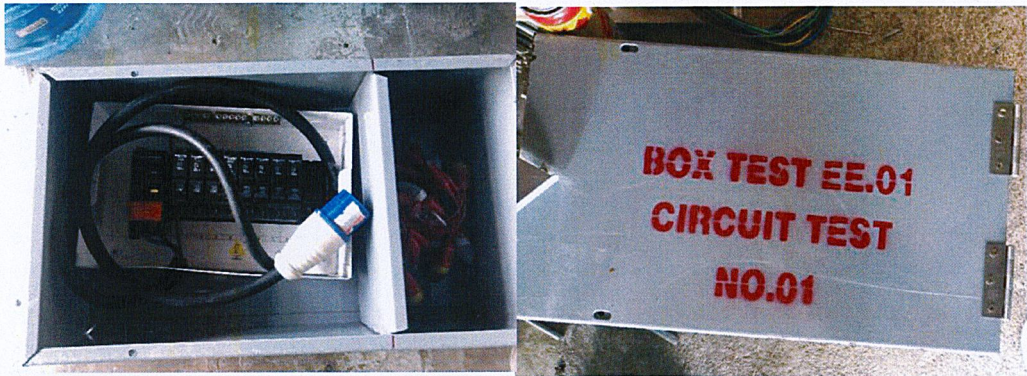
รูปที่ 3-2 กล่องเก็บอุปกรณ์ทดสอบระบบแสงสว่าง
