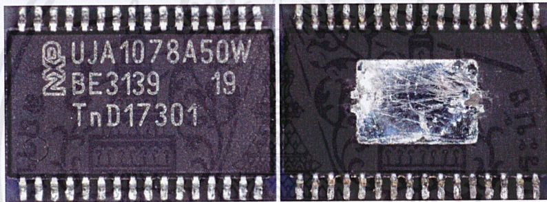
รูปที่ 4.4 : ตัว Reject ที่รับมาจาก Customer
