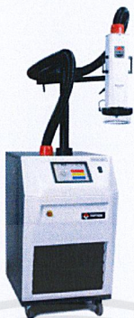
ภาพที่ 2.9 Tempronic ThermoStream ATS710 ที่มา : www.intestthermal.com
