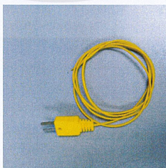
ภาพที่ 2.12 แสดงสาย Thermocouple Type K ที่ใช้เชื่อมต่อกับThermoStream
