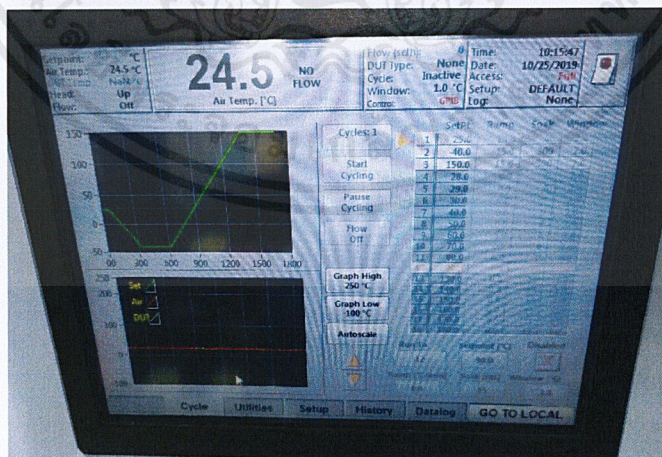
ภาพที่ 4.4 หน้าจอของ ThermoStream ขณะเขียนรายการอุณหภูมิ
