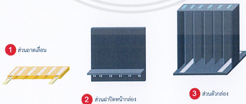
ภาพที่ 3.8 ภาพแบบร่างโครงสร้างของชิ้นส่วนต่าง ๆ
