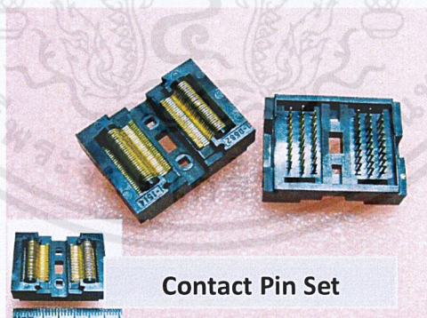
ภาพที่ 3.5 ตัวอย่างคอนแทคที่ประกอบมาเป็นชุด (contact pin set)
