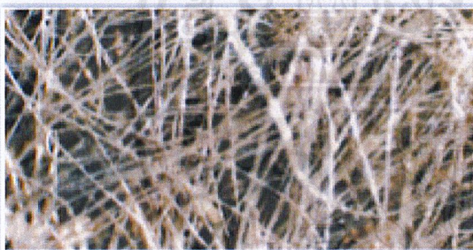
รูปภาพของผ้าโพลีเอสเตอร์ผ่านกล้องจุลทรรศน์อิเล็กตรอน
