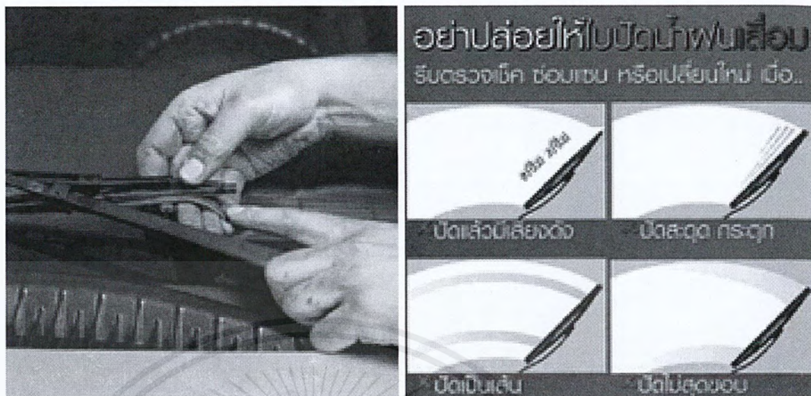
รูปที่ 2.43 : รูปตัวอย่างลักษณะยางปิดน้ำฝนที่เสื่อมสภาพ
