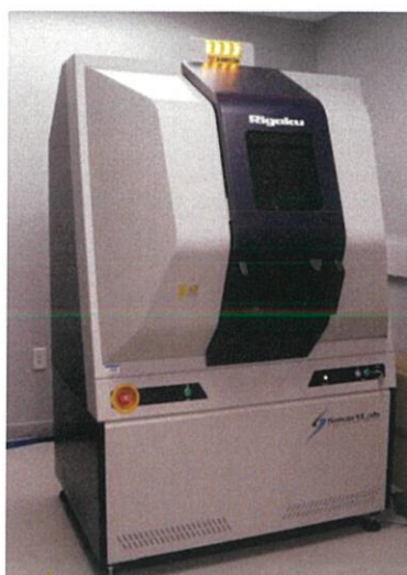
รูปที่ 3.4 เครื่อง X-Ray Diffractometer (XRD) รุ่น Smartlab จากบริษัท Rigaku
