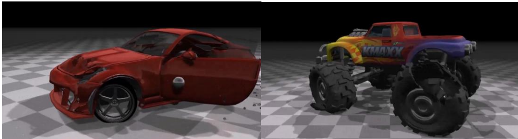
ภาพประกอบ 31 การจำลองเมชหลายเหลี่ยมใดๆด้วยการแทนด้วยวัตถุแกร่งหลายชิ้นโดยอัทโนมัติ เครดิต: [40]
