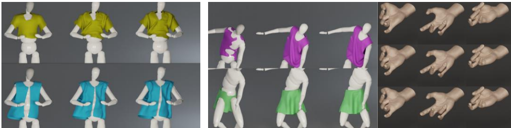
ภาพประกอบ 63) การใช้โครงข่ายประสาทเทียมที่ทำงานบนเมชสามเหลี่ยมในการ ซ้าย) เพิ่มความละเอียดของผ้า กลาง) แทนที่การจำลองผ้าด้วยฟิสิกส์ ขวา) แทนที่การจำลองผิวหนังของมือที่ขยับด้วยเนื้อที่ขยับเนื่องจากกระดูก ขยับ เครดิต: [91]
