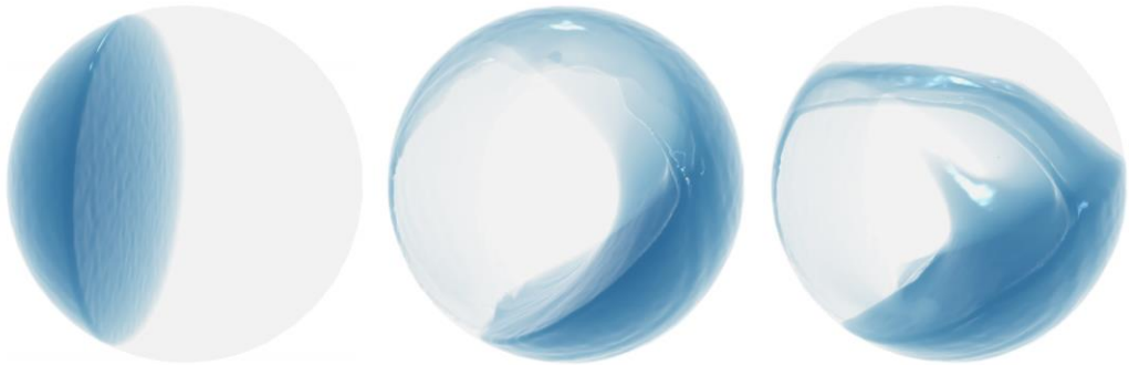
ภาพประกอบ 54: ซ้าย) สถานะเริ่มต้น กลาง) สถานะหลังจากที่น้ำไหลลงมาและติดกับภาชนะไม่สามารถแยกออกได้โดยอิสระ ขวา) สถานะหลังจากที่น้ำไหลลงมาและแยกออกจากภาชนะได้อย่างอิสระ เครดิต: [71]
