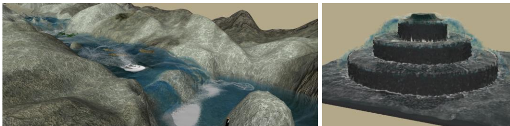
ภาพประกอบ 55: การจำลองน้ำโดยใช้ระบบสมการน้ำตื้นและใช้อนุภาคประเภทต่างๆในการเสริมความสมจริง เครดิต: [72]
