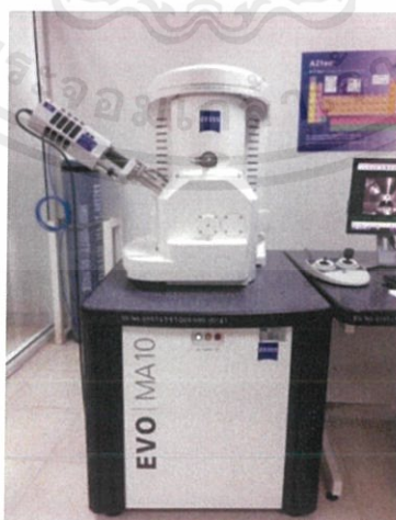
รูปที่ 3.8 เครื่อง Scanning Electron Microscopy (SEM) รุ่น Evo ma10 จากบริษัท ZEISS
