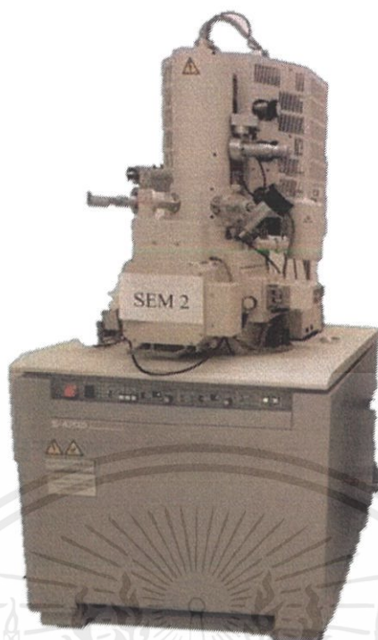
รูปที่ 3.5 เครื่อง Field-emission Scanning Electron Microscopy ของ บริษัท Hitachi รุ่น s 4700
