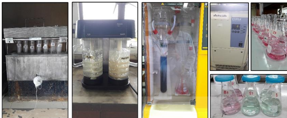
ภาพภาคผนวกที่ 3 แสดงการหาโปรตีนรวมของตัวอย่างที่นำมาวิเคราะห์ในห้องปฏิบัติการ
