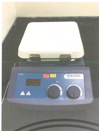
รูปที่ 3.7 เครื่องกวนสารชนิดให้ความร้อน ยี่ห้อ SCIOLOGEX รุ่น MS7-H550-S
