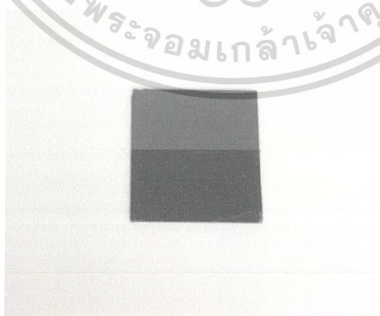
รูปที่ 3.16 แผ่นซิลิกอนเวเฟอร์ที่ถูกตัดแล้ว ขนาด 2 \times 2 \text{ cm}^2
