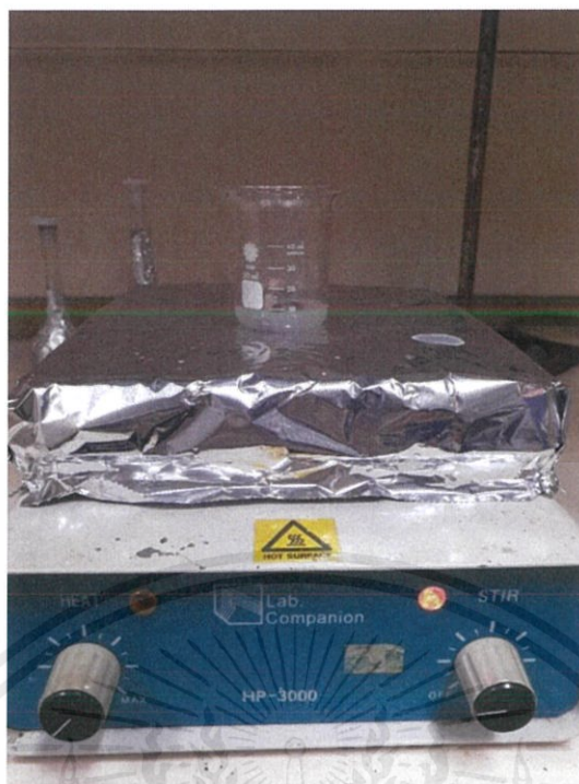
ภาพที่ 3.10 ขั้นตอนการปั่นกวนด้วยแม่เหล็กผสมคอมโพลีตอพออกซีเรซินกับผงแก้ว/อนุภาคนาโน ซิลิกอนไดออกไซด์ทางการค้า
