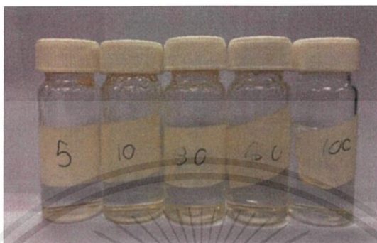
รูปที่ 3.15 แสดงการเก็บอนุภาคแม่เหล็กนาโนที่ถูกห่อหุ้มที่สังเคราะห์ขึ้นตามเงื่อนไขการเปลี่ยนแปลงความเข้มข้นของอนุภาคแม่เหล็กนาโน
