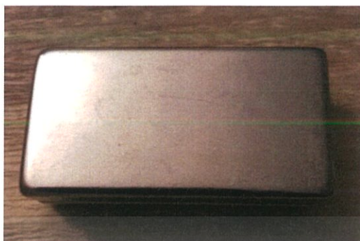
รูปที่ 3.12 แสดงวัสดุแม่เหล็กที่ใช้ในการให้สนามแม่เหล็กภายนอกแก่นูภาคแม่เหล็กนาโนที่ถูกห่อหุ้มในการศึกษาการซึมผ่าน
