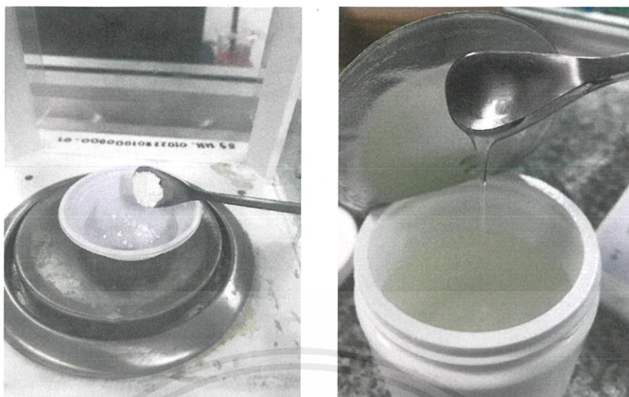
ภาพที่ 3.1 ขั้นตอนการผสมพอลิไดเมทิลไซลอกเซน กับอนุภาคนาโนแบเรียมไททาเนตที่อัตราส่วน 10wt% 20wt% 30wt% 40wt% และ 50wt%
