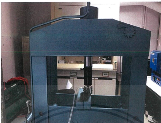
ภาพที่ 3.6 เครื่องอัดแรงดันทิศทางเดียว (uniaxial pressing)
