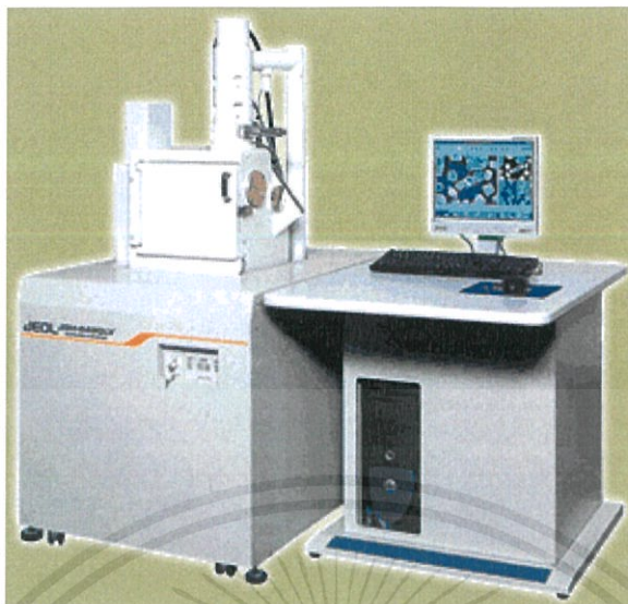
ภาพที่ 3.8 กล้องจุลทรรศน์อิเล็กตรอนแบบส่องกราด (scanning electron microscope : SEM )
