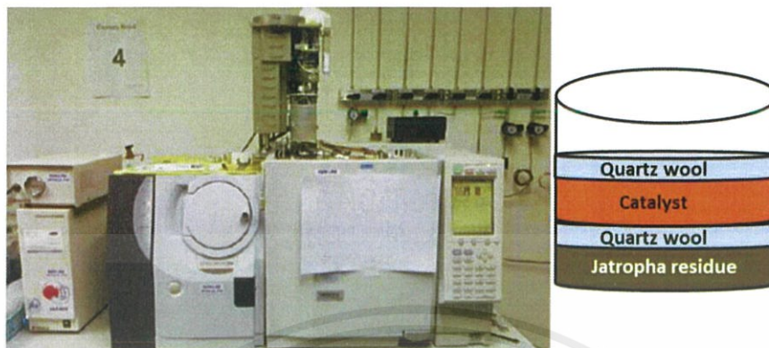
ภาพที่ 3.18 เครื่อง Pyrolysis-GCMS และถ้วยใส่ตัวอย่างและลำดับการใส่สารในการนำไปวิเคราะห์
